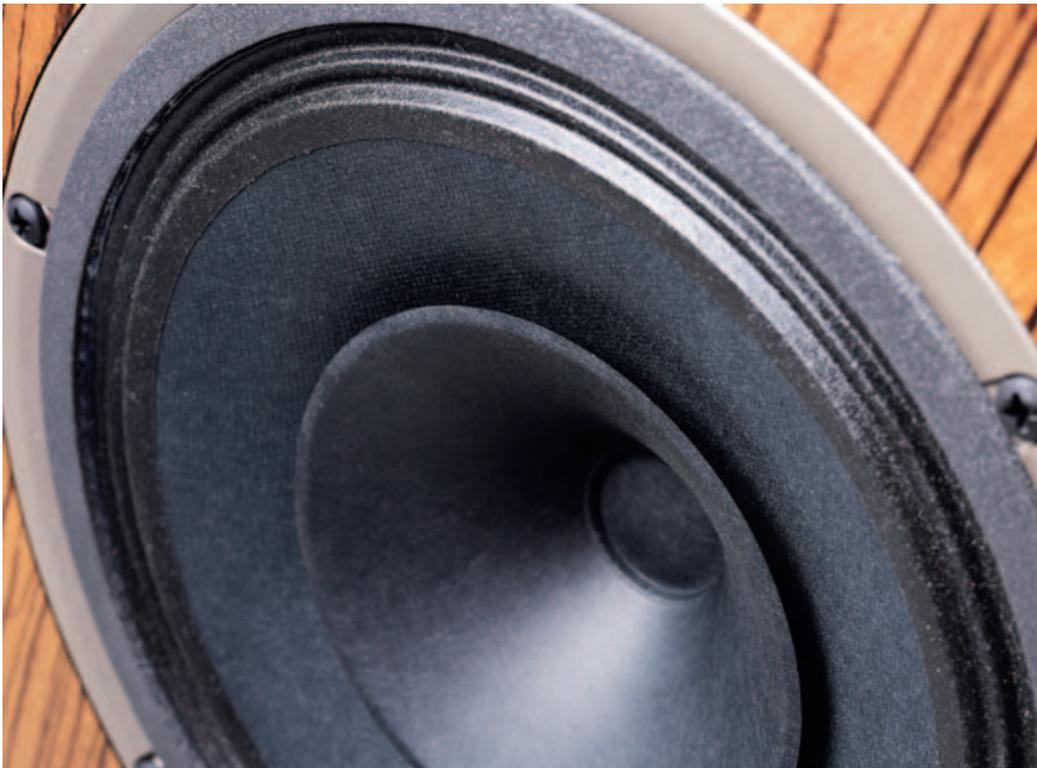
Wie nach alter Väter Sitte: Der Konus aus verstärkter Fasermembran ist mit einer mittelharten Sicke eingespannt und eher flach. Dahinter sitzt eine kleine Schwingspule, die auch den leichten Subkonus für die Wiedergabe höherer Töne treibt. Mittig kein Phaseplug, sondern eine Staubschutzkalotte.
