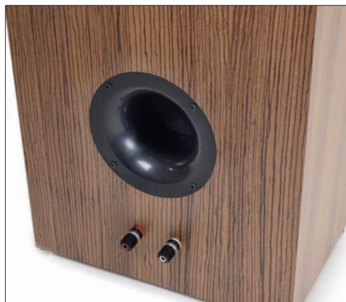
Das Reflexrohr ist großzügig verrundet und angesichts des Gehäusevolumens außergewöhnlich groß. Das entlastet den Breitbänder im Tiefbass recht breitbandig von großen Hüben.
