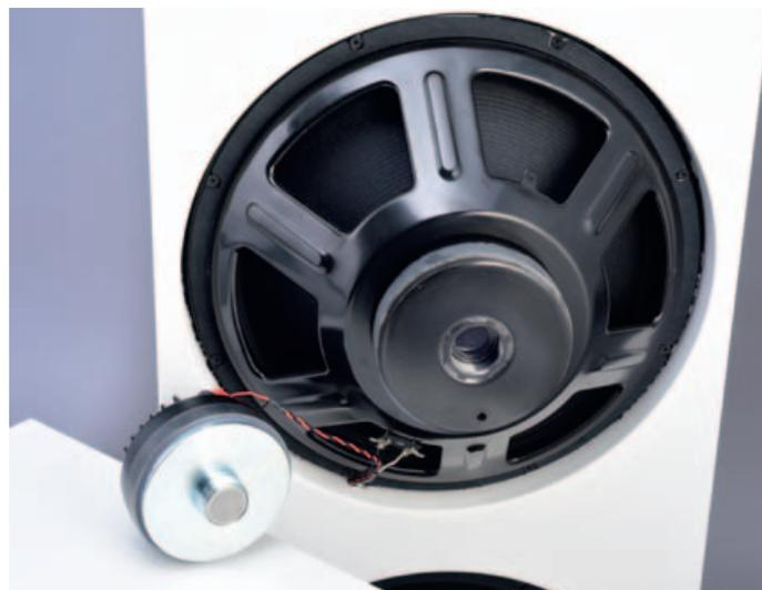
Der Hochtontreiber (links unten) wird per Schraubgewinde bombenfest mit der Polkernbohrung des 15-Zöllers mit PA-mäßigem Blechkorb verbunden und spielt durch diese koaxial hindurch.
