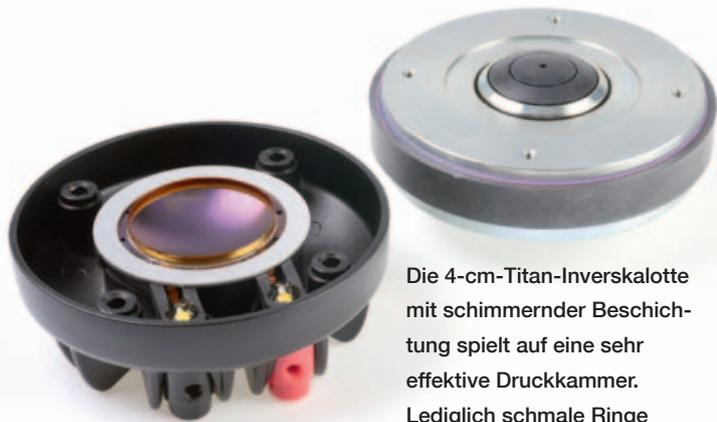
Die 4-cm-Titan-Inverskalotte mit schimmernder Beschichtung spielt auf eine sehr effektive Druckkammer. Lediglich schmale Ringe (oben) verdichten den Schalldruck zum Horn hin.
